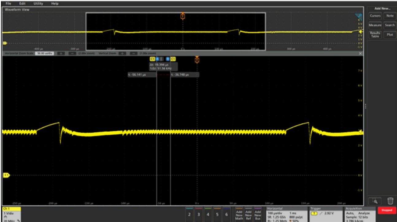
图 3-3. 使用 10nF C_sink 时的基准测试
