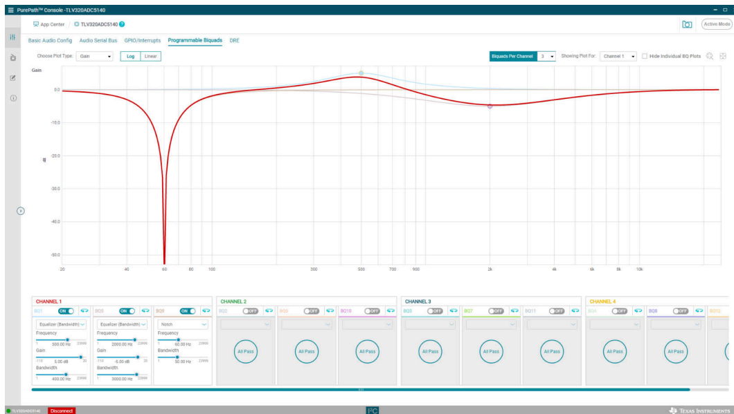
图 3-2. PurePath™ Console 可编程双二阶滤波器示例
