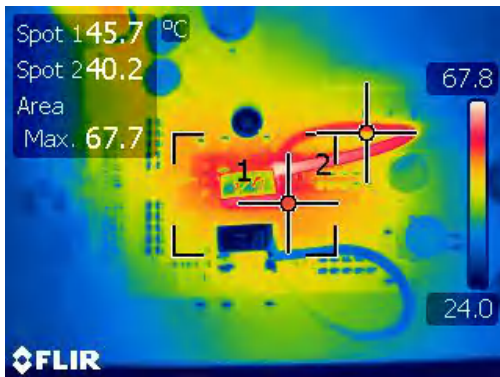
图 4-19. 单相升压中的热条件 ( V_{IN}=8V 且负载电流为 4A )
