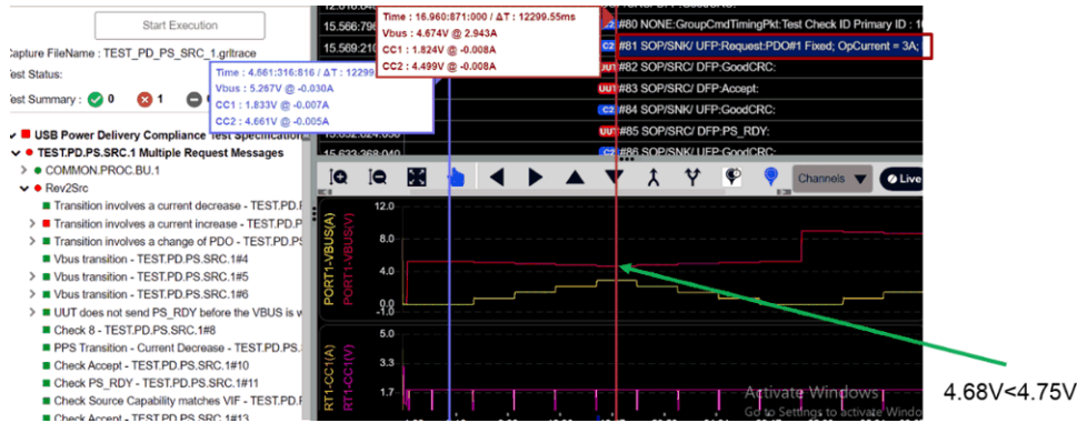
图 5-4. TEST.PD.PRO.SRC.2 的 GRL-C2 数据日志
