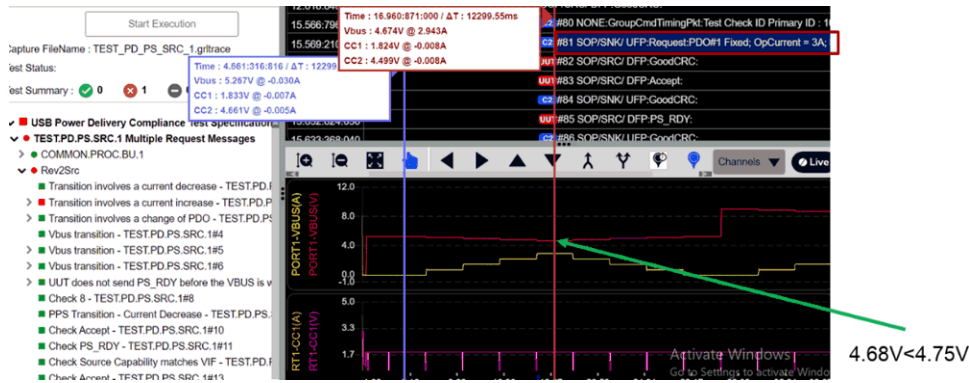
图 5-6. TEST.PD.PS.SRC.1 的 GRL-C2 日志
