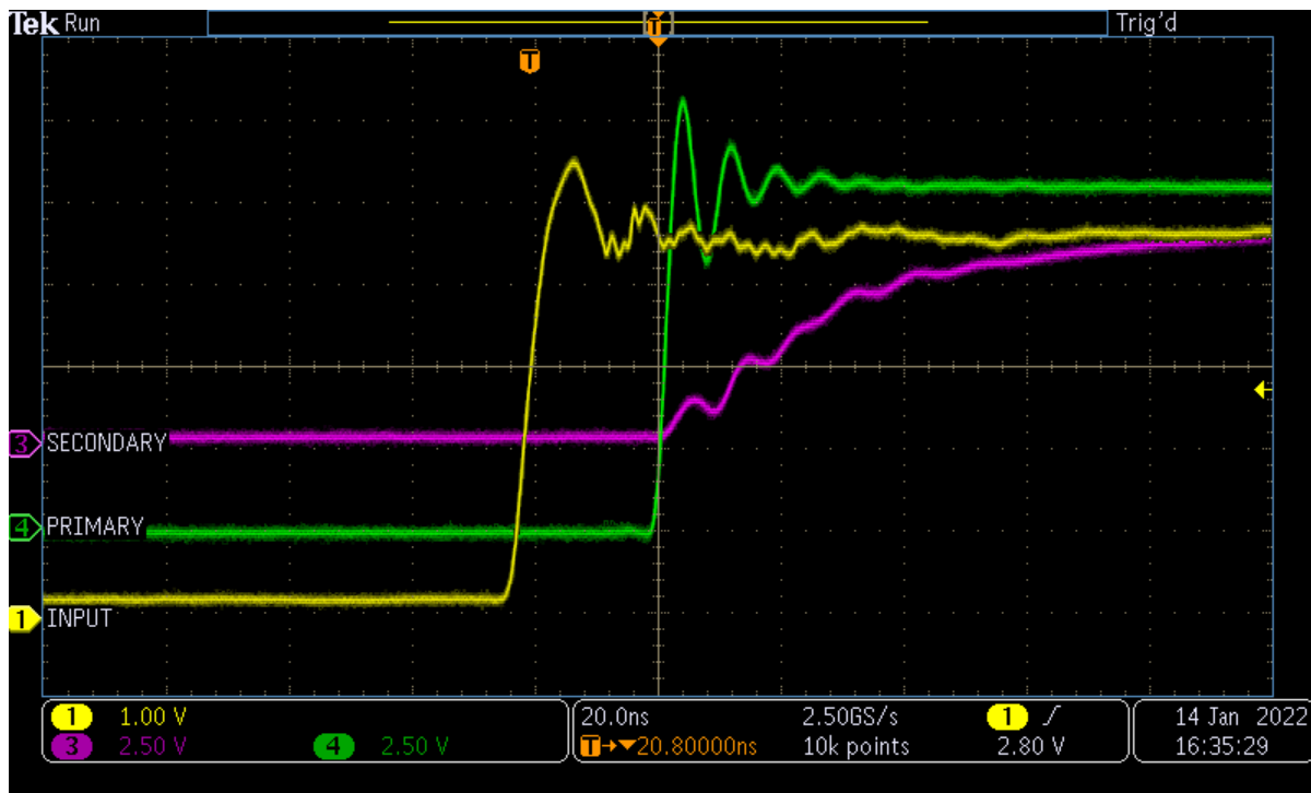
图 3-1. 显示电路中驱动器 IC 和变压器传播延迟的示波器捕获
