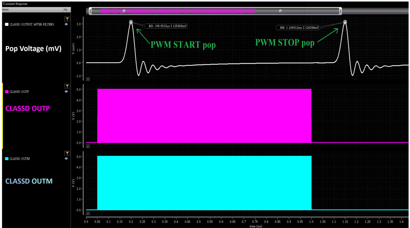
图 2-2. 测量的由于 D 类 PWM 的启动和停止而产生的砰砰声
