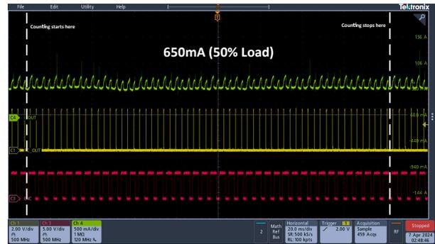
图 4-11. 误差校正器关闭 (50% 负载)
