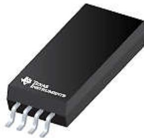
图 3. DWL 封装，8 引脚 SOIC
