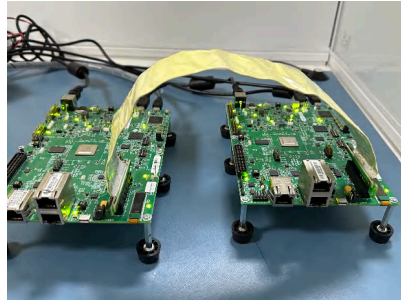
图 4-2. 通过未修改的 PCIe 电缆连接两个 AM64x
