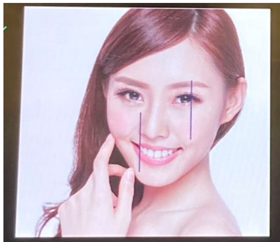
图 2-10. LED 显示问题 - 毛毛虫现象
