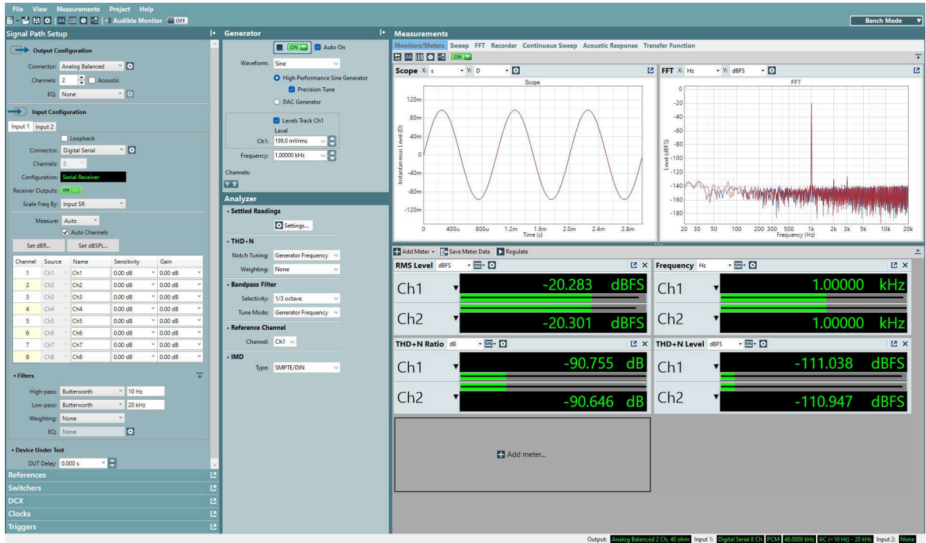
图 3-17. 在启用 DRE 的情况下使用 ADC6120 捕获最大麦克风输入
