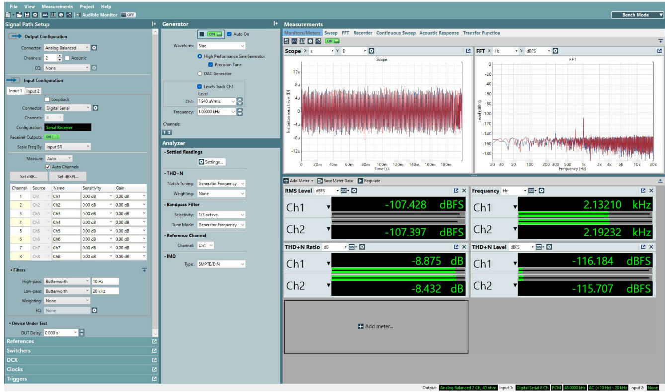
图 3-2. 使用 TAA5212 捕获最小麦克风输入
