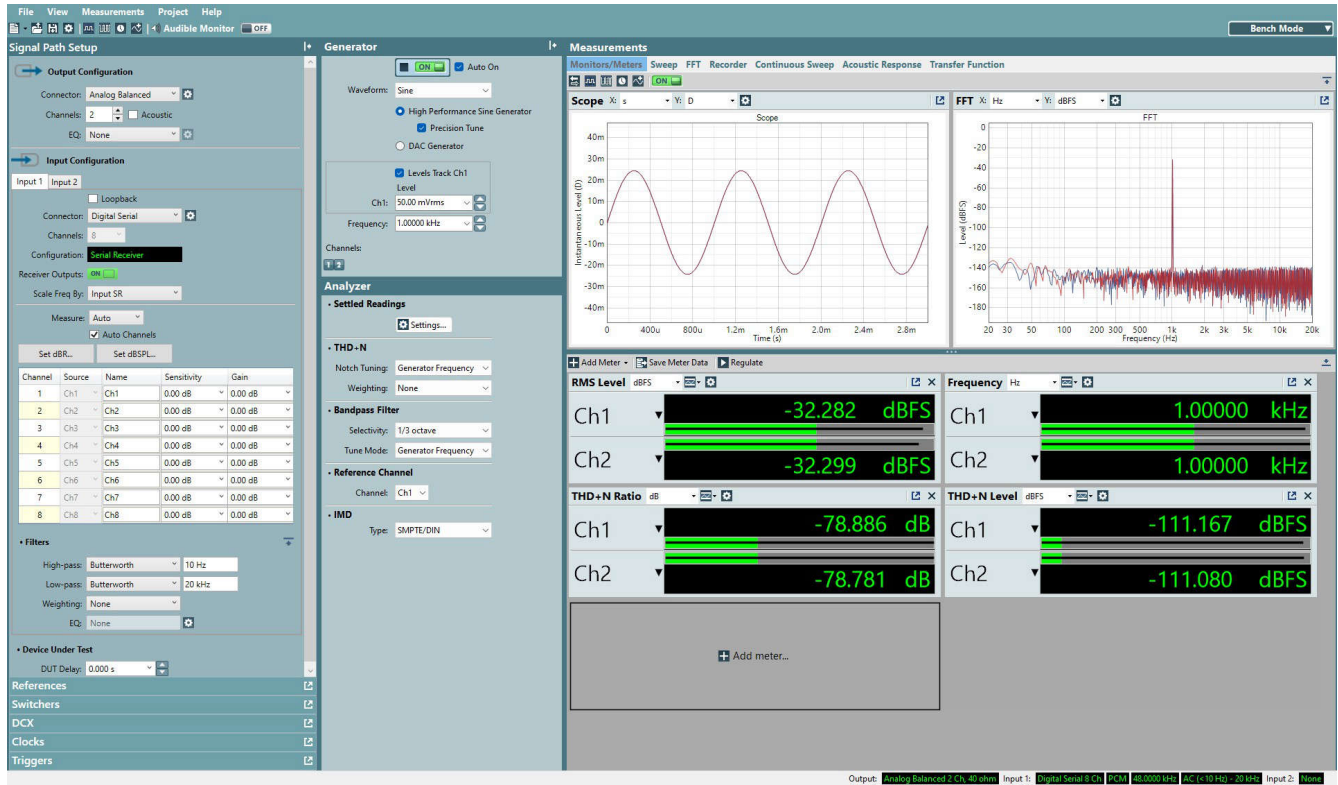
图 3-6. 在禁用 DRE 的情况下使用 ADC6120 捕获最大麦克风输入
