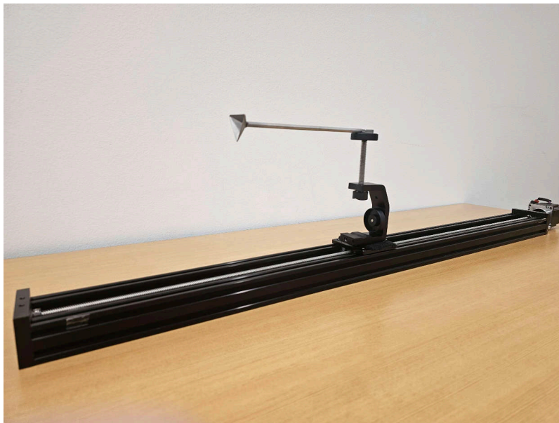
图 7-1. 线性传动器的图片，其中带有静态残余移动的指定尺寸角反射器
