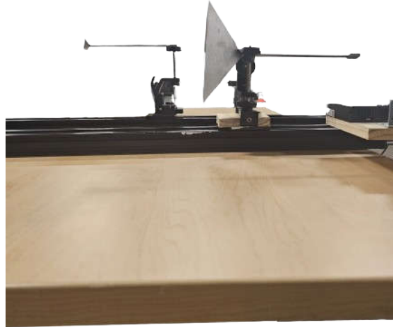
图 4-4. 用于检测区域外物体的干扰功能测试的设置的图像
