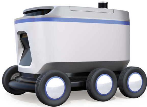
图 2. 机械扫描激光雷达模块位于顶部的自主移动机器人 (AMR)
