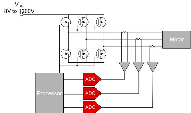
图 2. 测量电流传感器的输出
