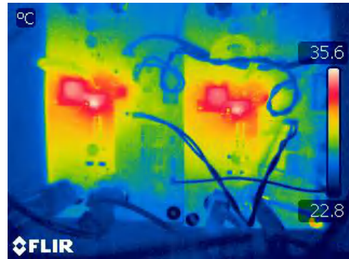
图 4-20. 双相升压中的热条件 ( V_{IN}=12V 且负载电流为 2A)
