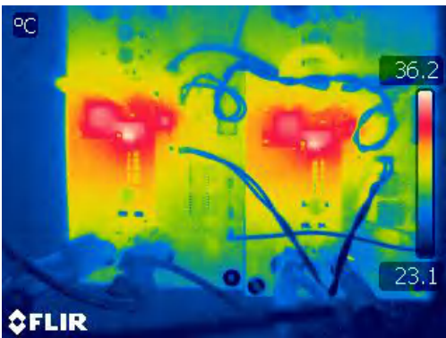
图 4-13. 升压区域中的热条件 ( V_{IN}=15V 且负载电流为 2A)
