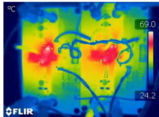
图 4-16. 降压/升压区域中的热条件 ( V_{IN}=20V 且负载电流为 8A)
