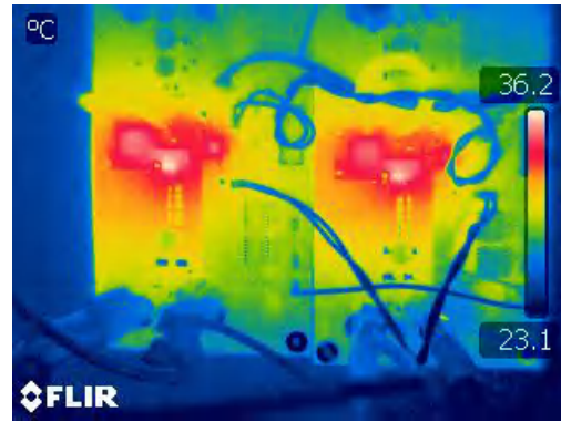
图 4-24. 双相升压中的热条件 ( V_{IN}=15V 且负载电流为 2A)
