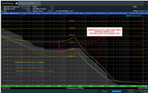
图 5-5. 10MHz 基准输入至 LMX2820 100MHz 输出，带或不带缓冲器（用例 1：T1 至 T3，用例 2：T4 至 T6，输入功率：-10dBm、0dBm、14dBm）
