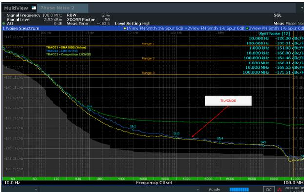
图 6-5. 100MHz 输出时的总相位噪声
