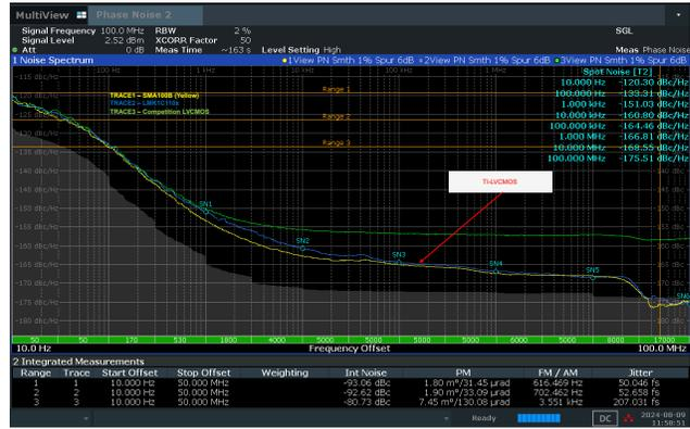
图 6-10. RMS 抖动 (10Hz 至 50MHz) : 100MHz 输出 - LMK1C110x 与竞品比较
