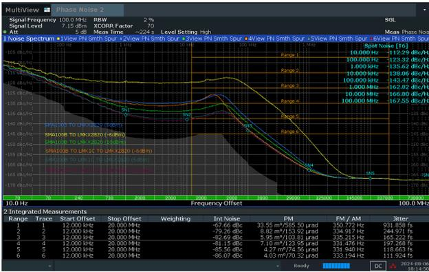
图 5-7. 总 RMS 抖动 (12kHz 至 20MHz) : 10MHz 基准输入至 LMX2820 100MHz 输出, 带或不带缓冲器 (用例 1 : T1 至 T3, 用例 2 : T4 至 T6, 输入功率 : -6dBm、5dBm、10dBm)
