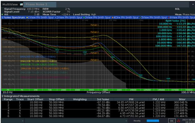
图 5-11. 总 RMS 抖动 (10Hz 至 50MHz) : 10MHz 基准输入至 LMX2820 100MHz 输出, 带或不带缓冲器 (用例 1 : T1 至 T3, 用例 2 : T4 至 T6, 输入功率 : -6dBm、5dBm、10dBm)
