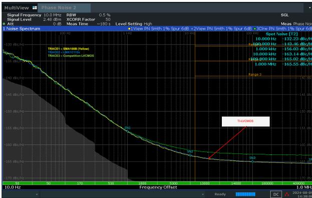
图 6-3. 10MHz 输出时的总相位噪声
