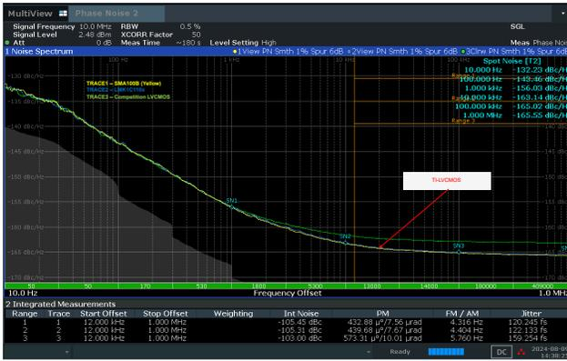
图 6-7. RMS 抖动 (12kHz 至 1MHz) : 10MHz 输出 - LMK1C110x 与竞品比较
