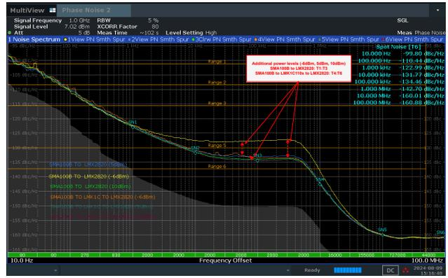
图 5-4. 100MHz 基准输入至 LMX2820 1GHz 输出，带或不带缓冲器（用例 1：T1 至 T3，用例 2：T4 至 T6，输入功率：-6dBm、5dBm、10dBm）
