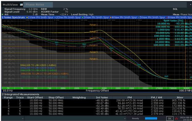
图 5-13. 总 RMS 抖动 (10Hz 至 50MHz) : 10MHz 基准输入至 LMX2820 1GHz 输出, 带或不带缓冲器 (用例 1 : T1 至 T3, 用例 2 : T4 至 T6, 输入功率 : -6dBm、5dBm、10dBm)
