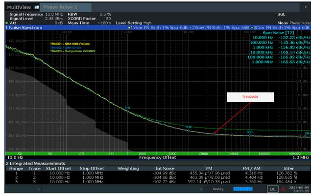
图 6-8. RMS 抖动 (10Hz 至 1MHz) : 12MHz 输出 - LMK1C110x 与竞品比较
