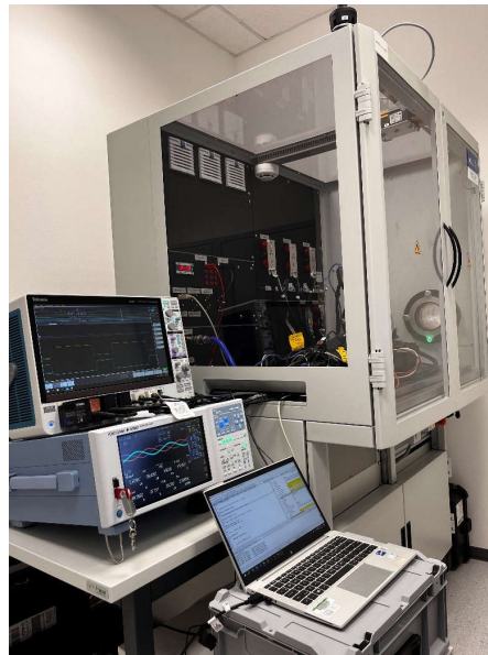
图 3-2. Wolfspeed 实验室中的逆变器测试设置
