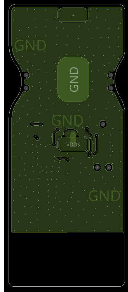
图 3-6. 2 层 PCB 设计的底层
