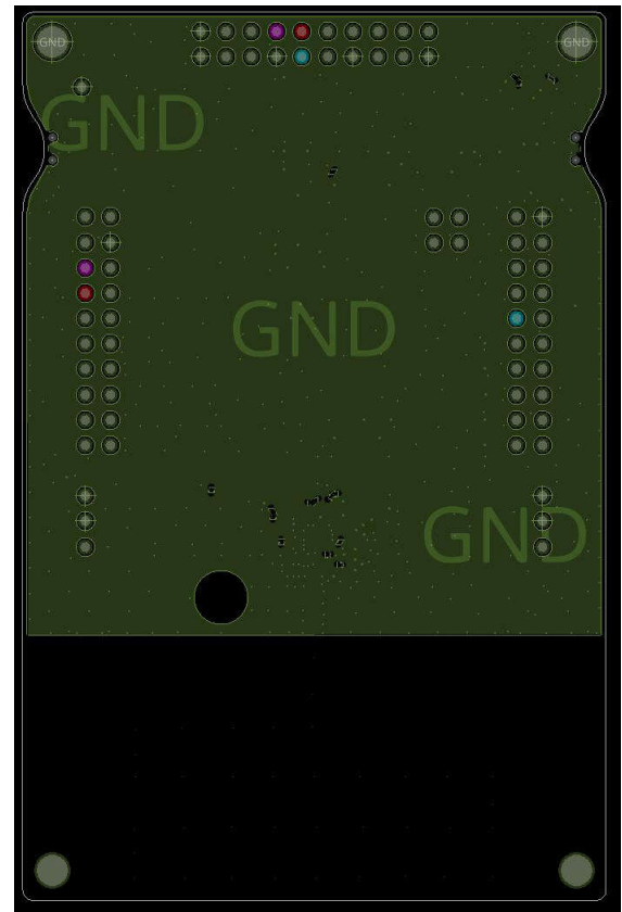
图 3-2. 4 层 PCB 设计的第二层
