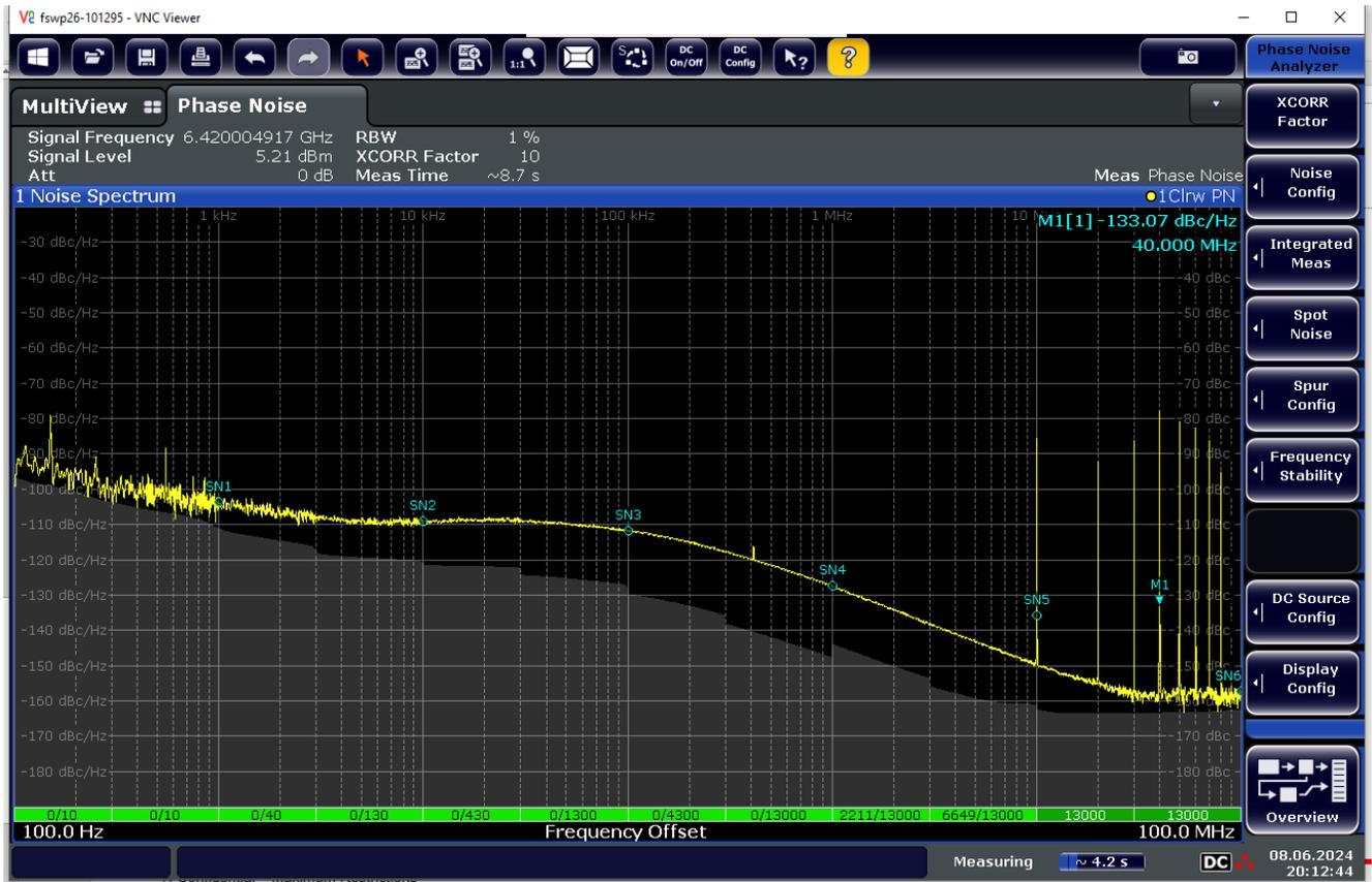
图 16. 电荷泵增益降低后的三阶 (器件 PN 图)
