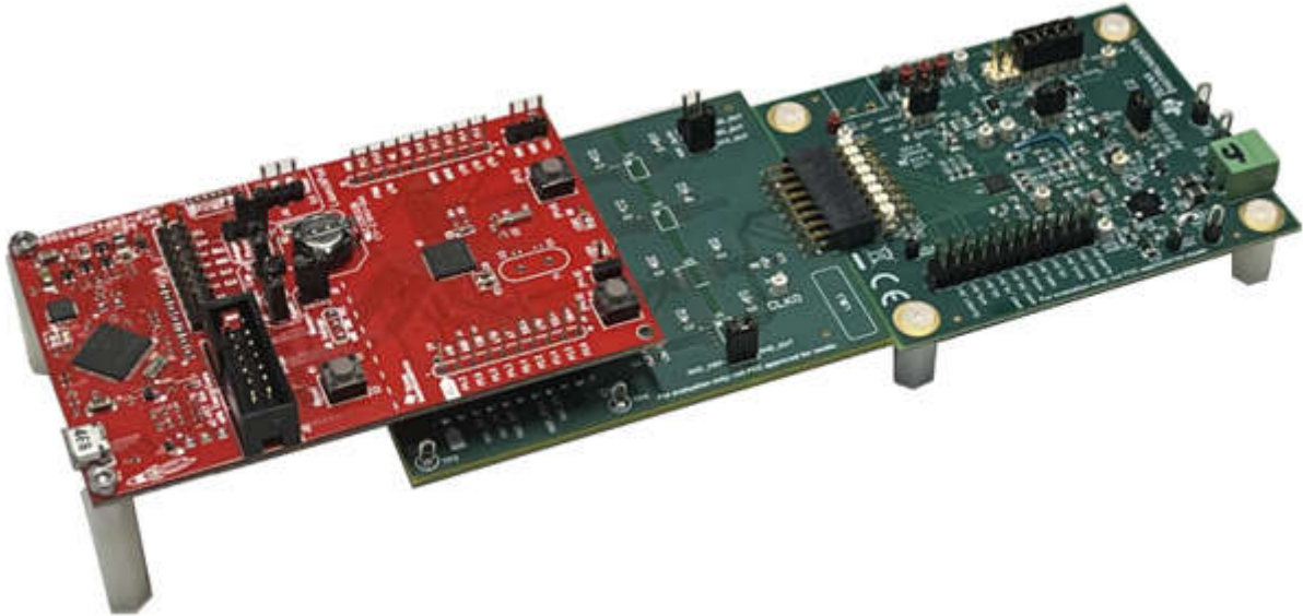
图 4-4. 用作 HART 变送器的 AFE882H1 前端电路板以及数字后端电路板和 MSP430FR5969 LaunchPad
