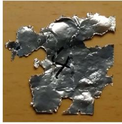
图 3-13. 使用自来水进行超声波清洁后的铝箔
