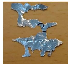
图 3-12. 使用去离子水进行超声波清洁后的铝箔
