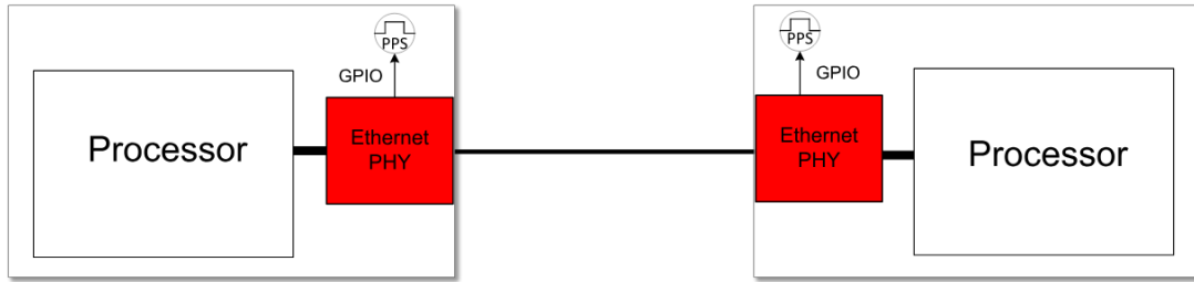
图 4-1. DP83TG721 PPS 同步设置：当 PTP 在后台运行时，GPIO 引脚从 PHY 生成 PPS 信号
