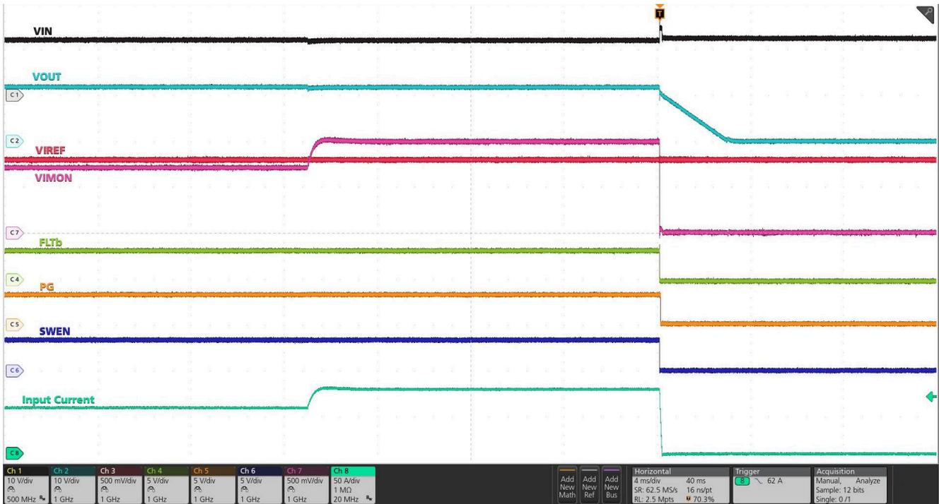
图 4-3. TPS25990 电子保险丝中的过流保护
