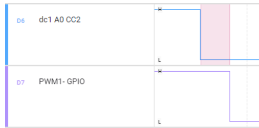
图 3-2. PWM 和 GPIO 之间的延迟
