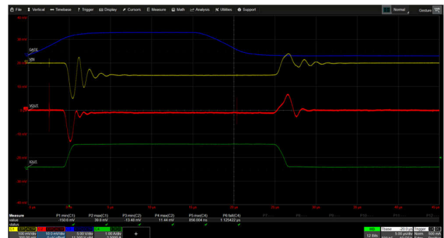
图 4-2. 具有有限寄生效应的 TPS7A96 负载瞬态
