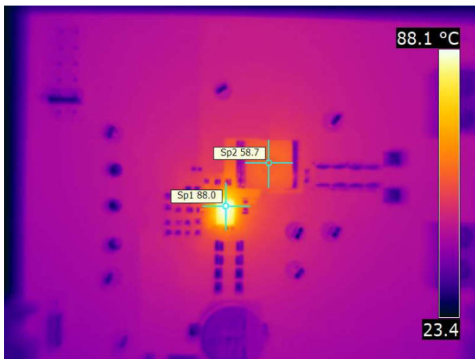
图 3. TPS548B28EVM 在 12Vin、1Vout、800kHz、20A 时的热成像图
