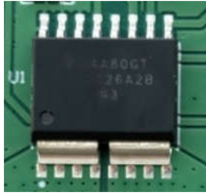
图 2-2. SOIC-10 封装在 SOIC-16 焊盘布局上
