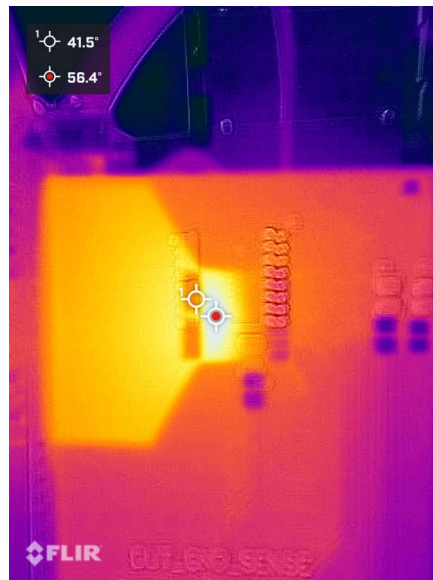
图 2-16. SOIC-10 封装在 SOIC-16 焊盘布局上，初始时刻，SAC 免清洗焊膏
