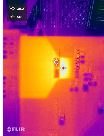
图 2-13. SOIC-10 封装在 SOIC-16 焊盘布局上，初始时刻，SAC 水溶性焊膏
