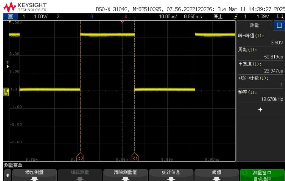
Figure 14. 934 DVP Hsync 一个周期波形
