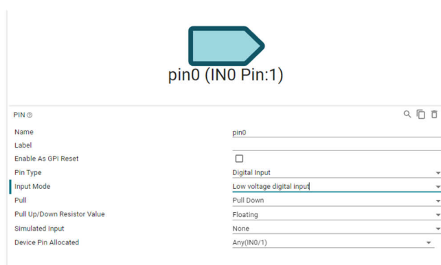
图 2. 显示低压数字输入的 ICS 引脚设置
