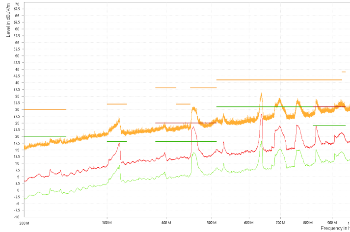
图 2-13. 采用 FB 的 CISPR25 RE LPA , Pout=0.5W
