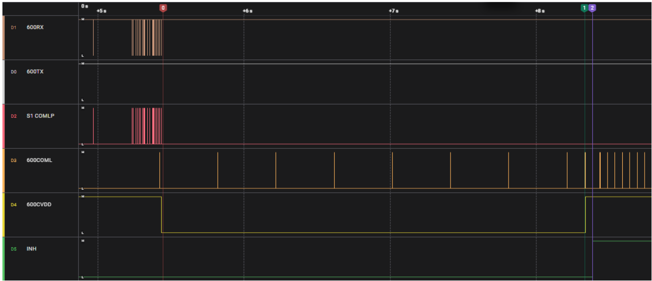
图 3-4. BQ79600 运行在 Shutdown mode 下实现的反向唤醒逻辑分析仪数据
