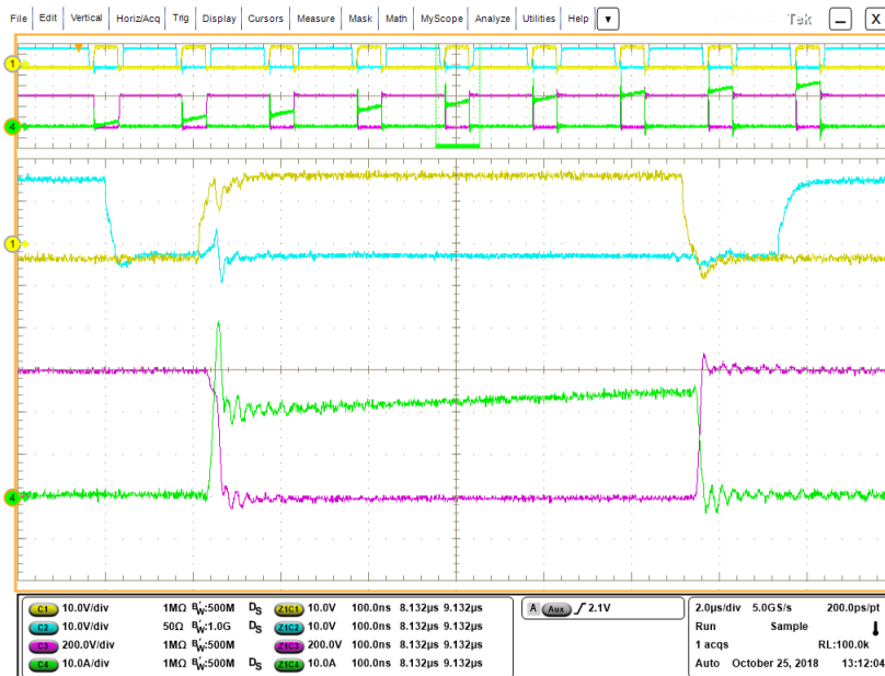
图 8-6. SiC MOSFET 开关波形
