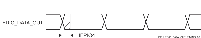
图 7-111. PRUSS IEP 数字 IO 时序要求
