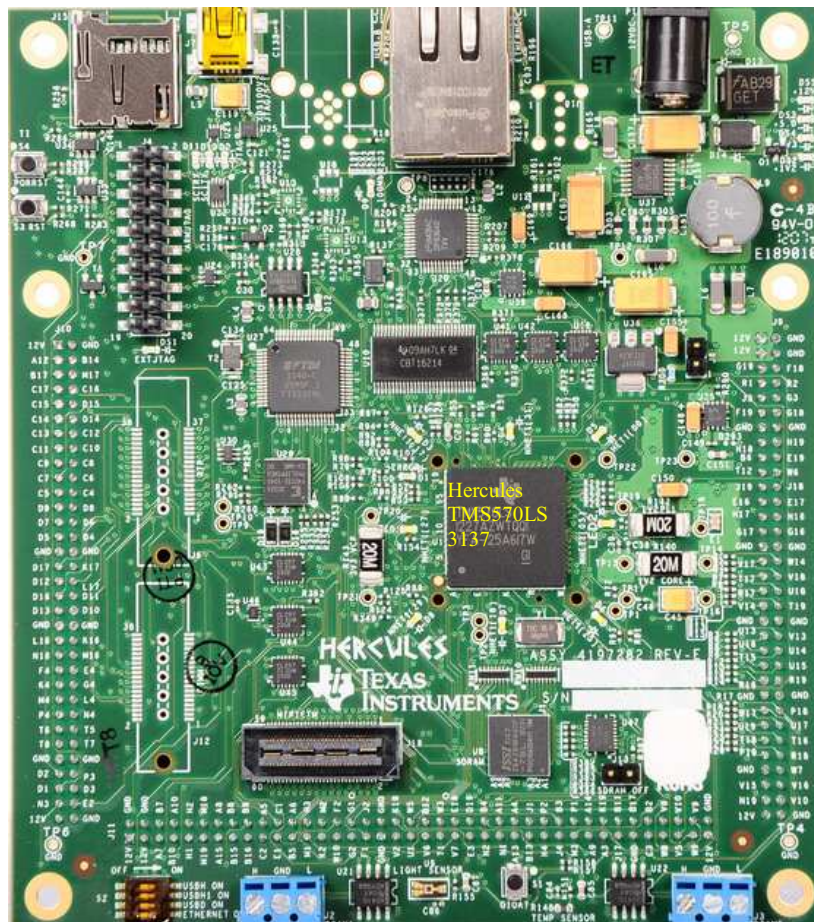
图 2-1. TMS570LS31HDK 电路板，接口顶部
