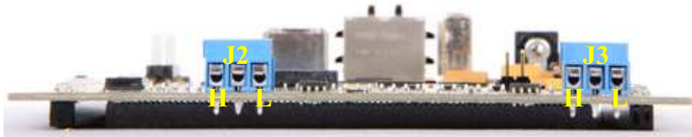
图 2-4. J2, J3 CAN 总线接口 (螺钉压线端子)
