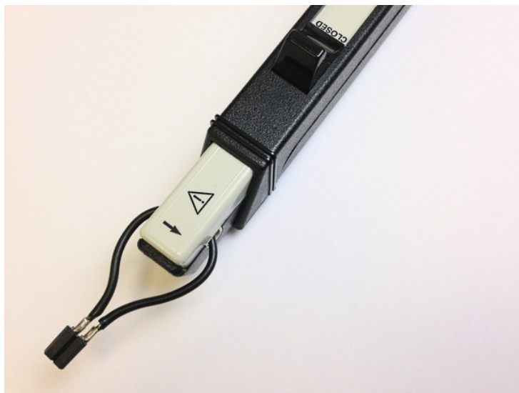
图 23. 用于测量初级侧电流的电流探针与自制适配器组合
