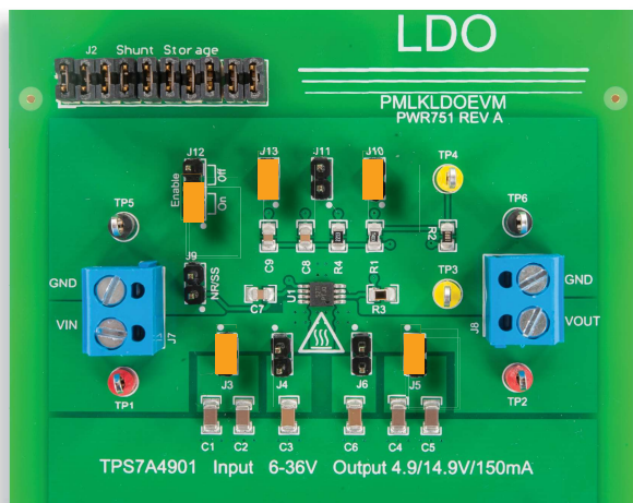
(a) 受测的 TPS7A4901 LDO 稳压器
