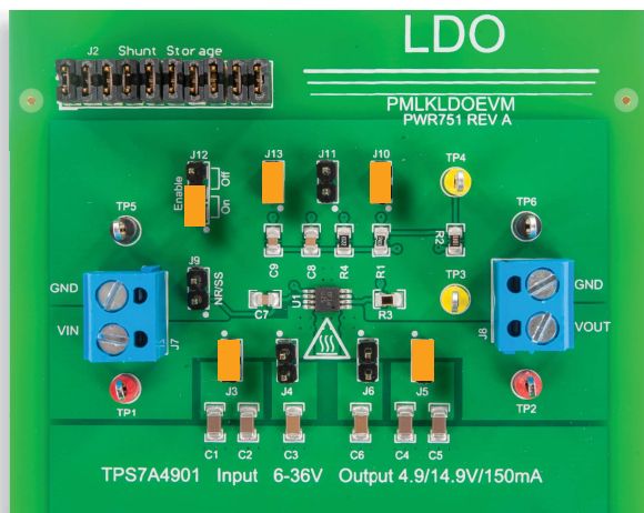
(a) 受测的 TPS7A4901 LDO 稳压器
