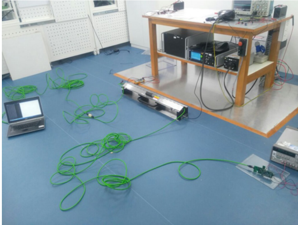
图 20. TIDA-00928 板的持续通信测试设置
