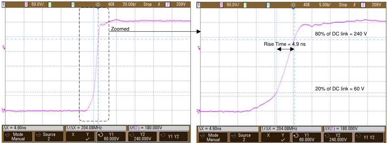
图 27. 1.6A 电流下的关断转换
