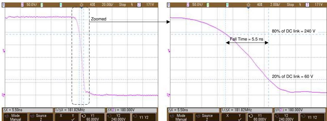
图 25. 1.6A 电流下的导通转换
