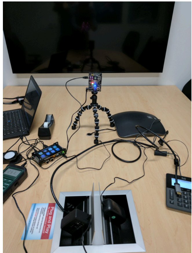
图 24. 3D ToF Functional Test Setup
