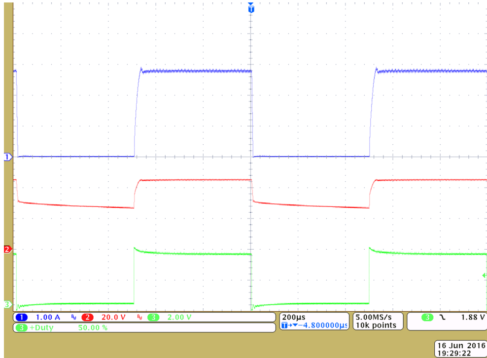
图 26. 50% 占空比时的 LED 电流、LED 电压和 UDIM 输入波形
