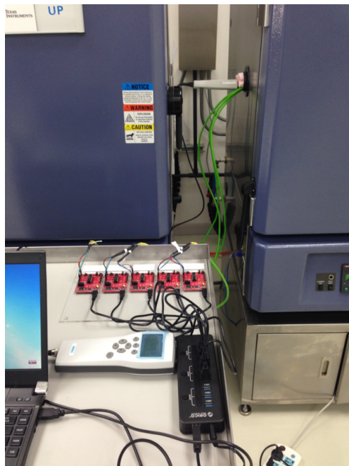
图 10. 带湿度和温度室的测试设置
