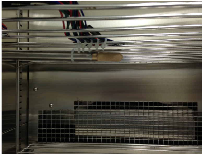
图 12. 接受测试的传感器和参考传感器的放置
