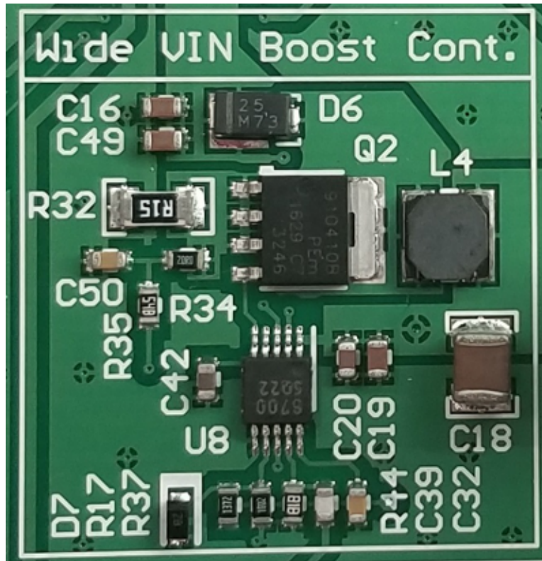
图 13. LM5022-Q1 Boost Controller Circuitry on PCB
