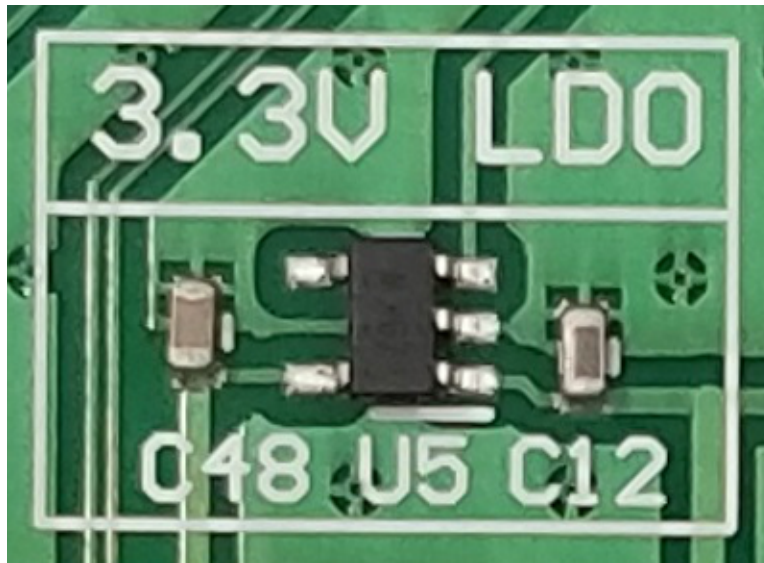
图 17. TLV71333P-Q1 LDO 电路在 PCB 上的照片
