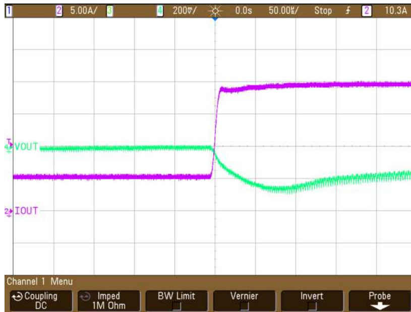
图 9. Load Transient Response
