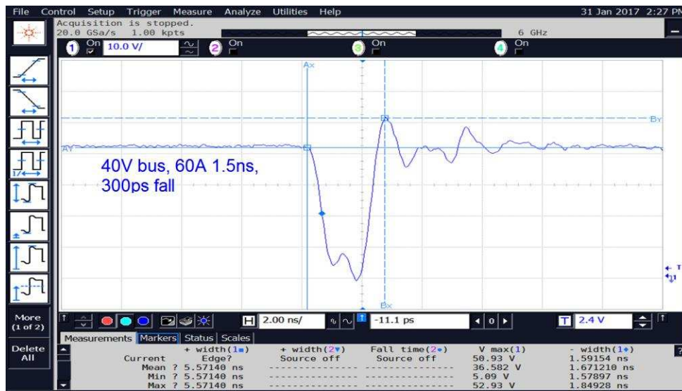
图 13. V_{DS} for 1.5-ns Pulse With 40 V of Bus Voltage
