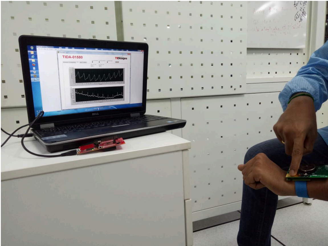
图 3-23. 用于采集数据的测试设置
