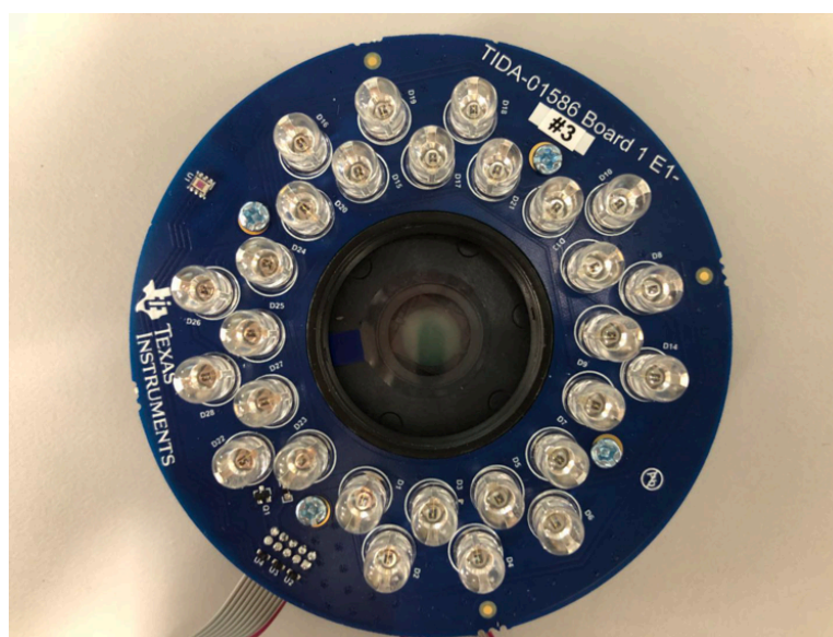
图 19. IR LED Array and ALS Board (Board-1)
