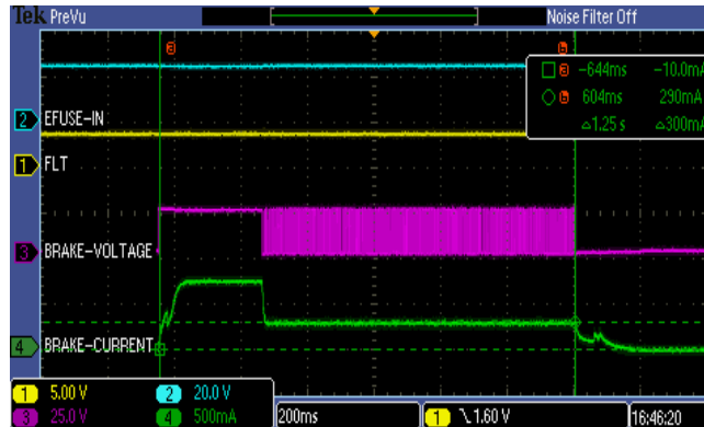
图 18. 功能性的 E-Fuse, TPS26600
