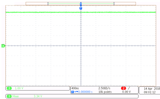
图 32. 使用 REF2033 生成的 3.3V 电压轨
