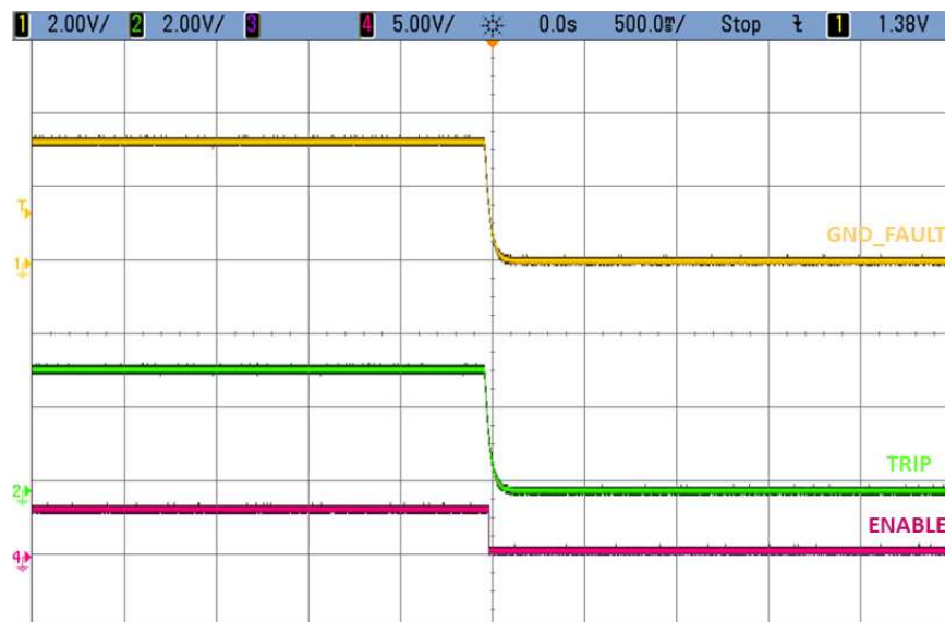
图 77. GND_FAULT 检测信号被锁存在 TRIP 引脚上
