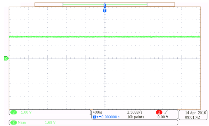
图 33. 使用 REF2033 生成的 1.65V 电压轨
