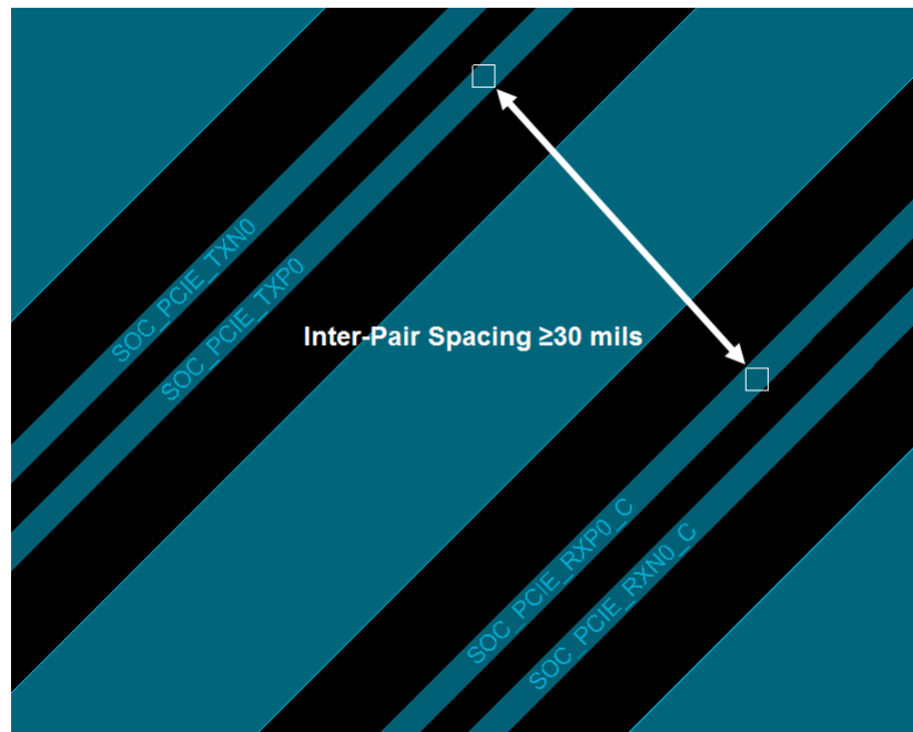
图 6. K2G GP EVM Inter-Pair Spacing
