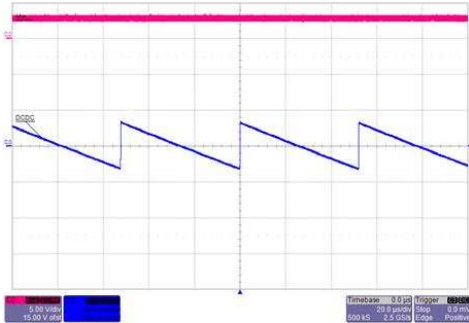
图 16. TPS62801 Output Ripple ( V_{IN} = 3\text{ V} , Load = 1 mA)
