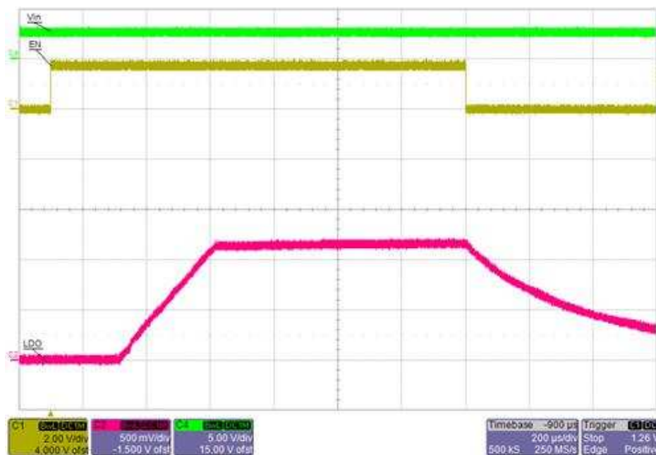
图 35. TPS7A10 启动和关闭 ( V_{IN} = 3\text{ V} , Load = 0 A)
